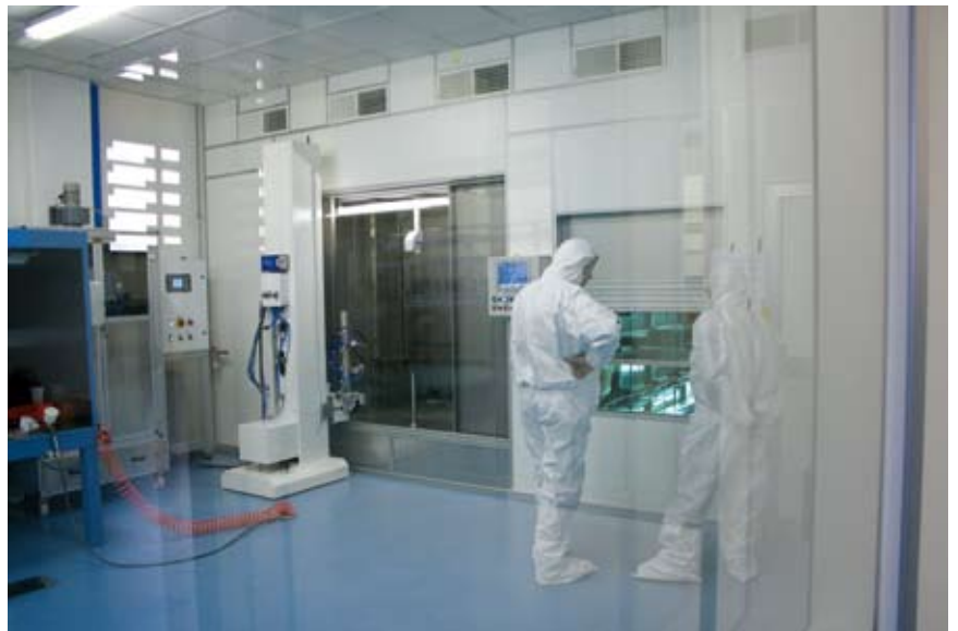
6 – La instalación de aplicación y polimerización UV del fondo en el que se depositarán los metales (acero inoxidable, níquel, cromo, cobre y otros metales) con el sistema sputtering .
