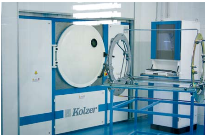
7 – A câmara a vácuo de deposição dos metais em ambiente plasma.
