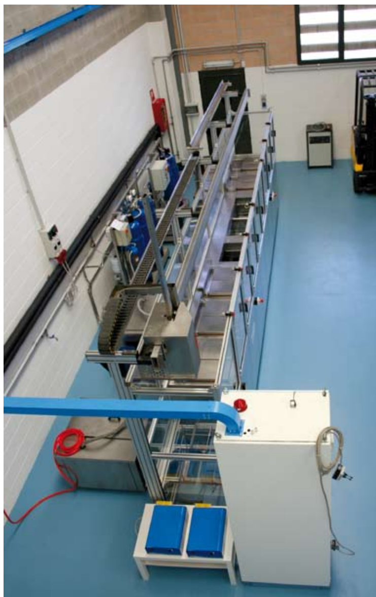
9 – La instalación de lavado por ultrasonidos para la preparación de los soportes que hay que revestir.
