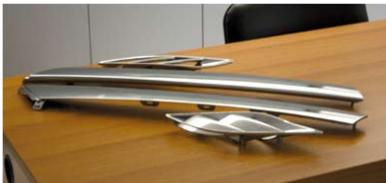
4 – Alguns componentes cromados com o sistema de sputtering desenvolvido pela Kolzer na fábrica da Sunagen.
