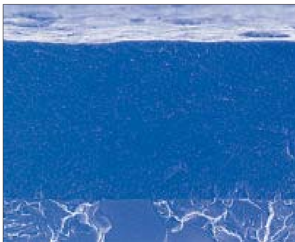
Fig. 2 La densa struttura nanocristallina dell'AITIN-Saturn, che qui vediamo in una sezione trasversale ingrandita 20 mila volte, assicura un'altissima durezza del rivestimento con eccellente tenacità e aumenta notevolmente la resistenza contro l'ossidazione. The dense nanocrystalline structure of AITIN-Saturn, here shown in a cross section magnified 20.000 times, assures a very high coating hardness combined with excellent toughness and notably increases the resistance against oxidation.
